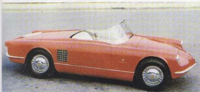
1956 L'Abarth 210/A aggiornata con due fanali anteriori, un parabrezza più protettivo e una presa d'aria laterale. Invariati il telaio, il materiale della carrozzeria, il motore 600 elaborato e l'assenza di accessori non utili nelle corse, come i tergicristalli e le maniglie delle porte
