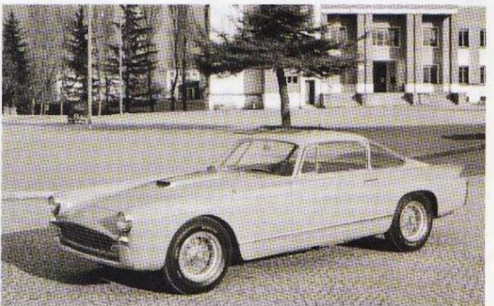
1956 La Ferrari 410 SA sul telaio # 0477 SA vista di ¾ anteriore. Lo stile è quello della # 0451 GT aggiornato alle esigenze della configurazione coupé. Si nota il muso molto abbassato sulla calandra a trapezio contornata dai paraurti che risalgono sui cantonali dei parafranghi
