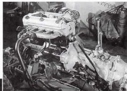
Der Doppelnocken des Acker-Alfa entspricht der 1900er Serie, das Getriebe ist fast unzerstörbar
