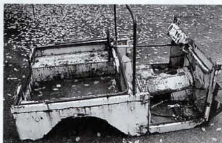
Servicefreundlich: Die gesamte Karosserie besteht aus vier miteinander verschraubten Teilen
