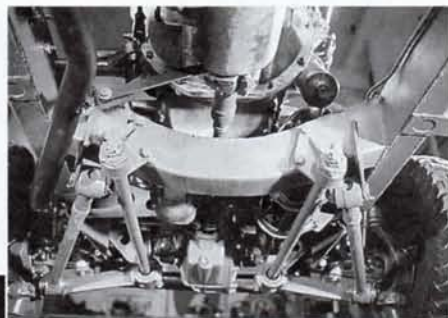
Aufwändige Vorderachskonstruktion: Die Räder werden über massive Drehstäbe abgedefert
