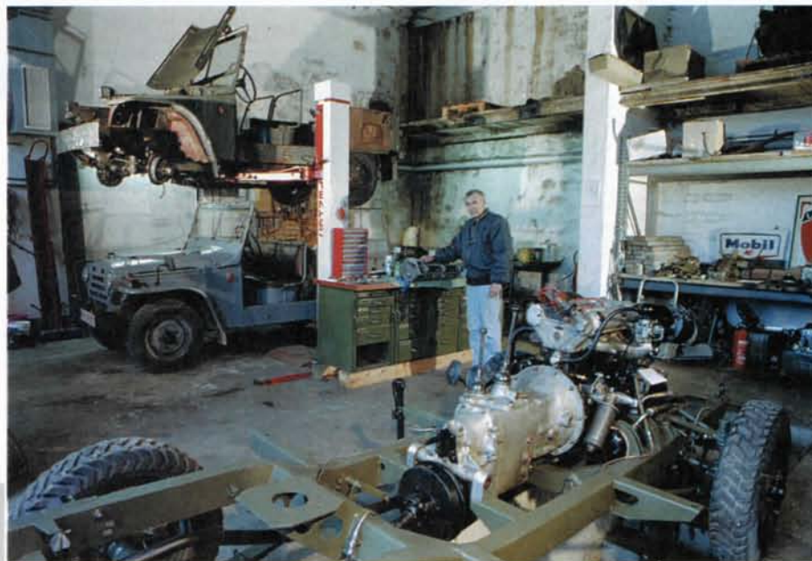
Ein solider Leiterrahmen, eine Karosserie, die fast nur rechte Winkel kennt, derbe Aufhängungen und ein großzügig dimensionierter Antriebsstrang – eine Matta-Restaurierung ist belleibe kein Hexenwerk
