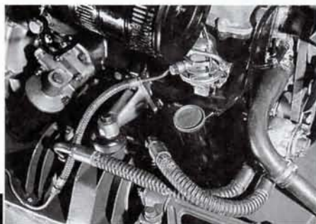
Der Allradantrieb benötigt Platz, deshalb wurde eine Trockensumpfschmierung nötig
